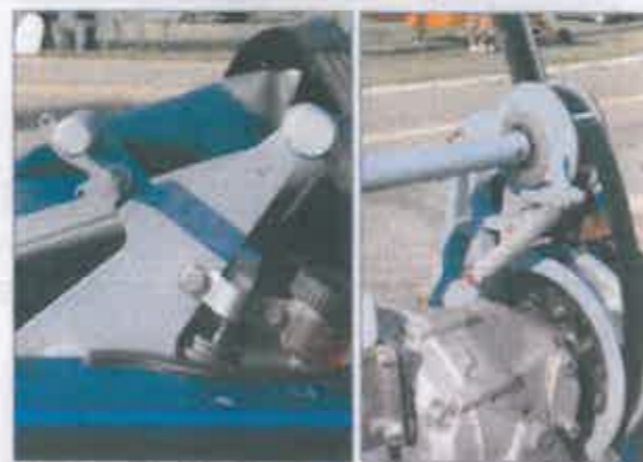
La cinghia sulla flangia elica aziona un alberino di trasmissione rigido.
