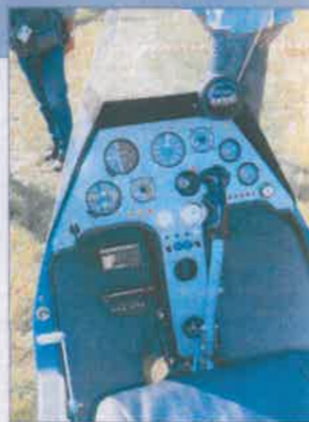
La leva della prerotazione è sul fianco sinistro. Davanti alla manetta del gas.
