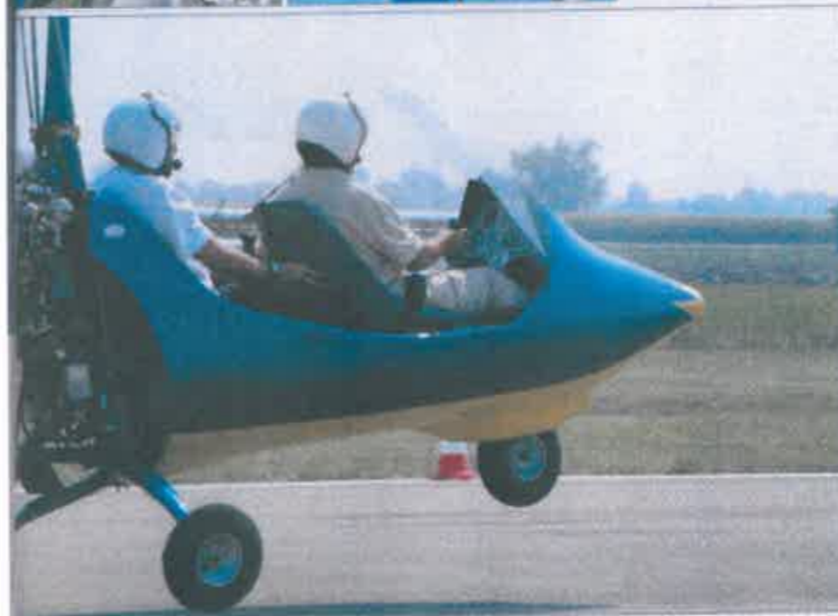
Il Rotax 914 consente prestazioni esuberanti, il 912S è probabilmente più adatto per l'utilizzo turistico.
