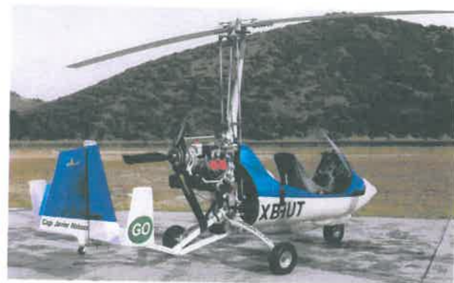
El autogiro ELA 07 está equipado con hélice impulsora tripala de fibra de carbono y puede utilizar el motor Rotax 912 de 100 hp o el Rotax 914 de 115 hp con turboalimentador.
