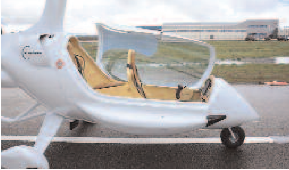
Eclipse występuje z dwoma wariantami kabiny – całkowicie zamkniętą (na zdjęciu) i częściowo odsłoniętą.
