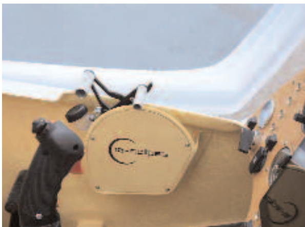
Dźwignie do sterowania silnikiem na lewej burcie kabiny
